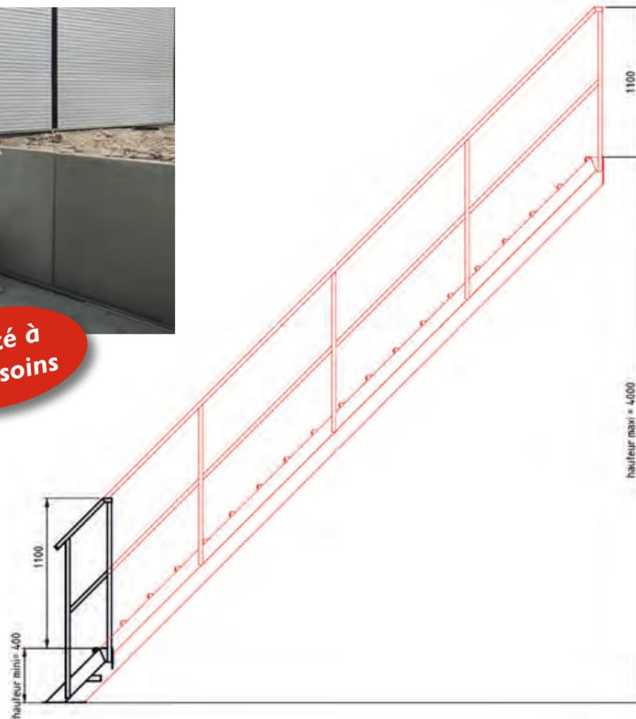
Conforme à la norme NF EN ISO 14122-3 en vigueur.
