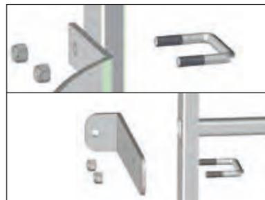
Fixation des pattes et des arceaux par un système d'étrier
